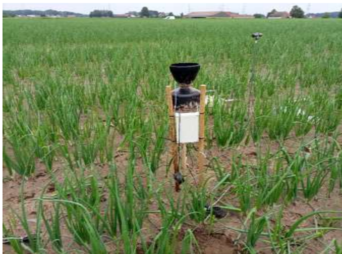
Figuur 1 Een communicatiemodule in een uienperceel waarbij neerslag wordt gemeten met een pluviometer en via een LPWAN netwerk wordt doorgezonden naar de BDB databank. De module is in dit geval ook verbonden met drie bodemsensoren die het vochtgehalte in de bodem meten.
