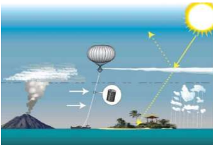
Het SPICE-project (Stratospheric Particle Injection for Climate Engineering) werkt aan een oplossing met stofdeeltjes in de stratosfeer. Hier zie je hoe dat werkt. Afbeelding: Hugh Hunt
